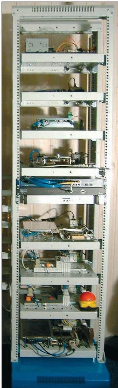
Im OSADL-Testrack sind auf 19-Zoll-Einschüben verschiedene Embedded-Systeme und Industrie-PCs montiert. In der Mitte befinden sich ein Power- und ein managed Ethernet-Switch. Jedes stabile Release wird vor der Freigabe auf derzeit 24 Systemen getestet.
